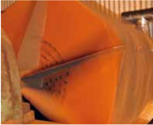
Grader avlägsnas från sidoskivorna genom trumling.
