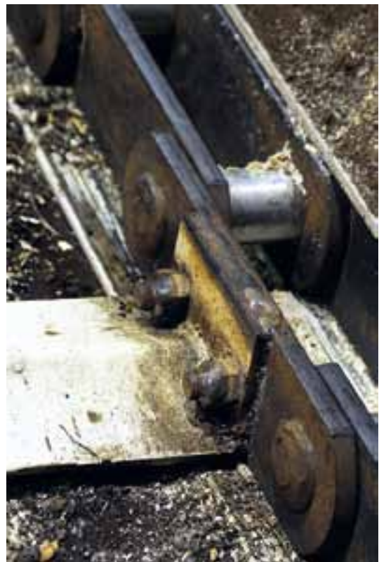
För mottagningsstationernas transportörer i värmeverk är de rostfria lederna ett gott val.
