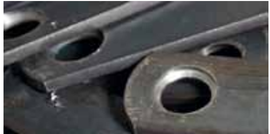
De inre brickorna fasas innan hylsorna svetsas.
