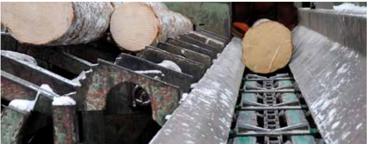
Polyamid har goda glidegenskaper och lämpar sig därmed exempelvis i transportörer för timmerhantering.
