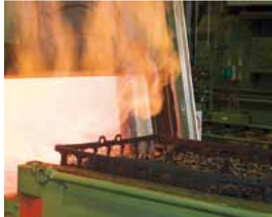
Härdningen i automatiska skyddsgasugnar ger kedjekomponenterna jämn kvalitet.
