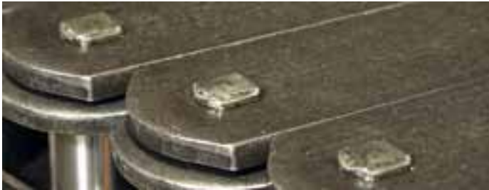
Nitningarna håller för materialutmattning, eftersom bultens ände är hård.
